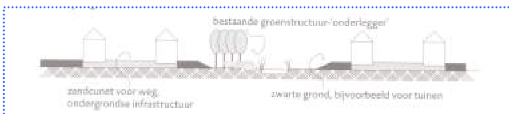
Figuur 2.4 Een voorbeeld van een ophoogmethode is partieel ophogen met zand 4
