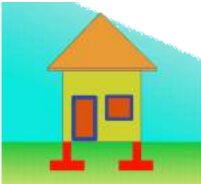
Figuur 6.5 Schematisatie fundering op staal (bron: wikipedia)
