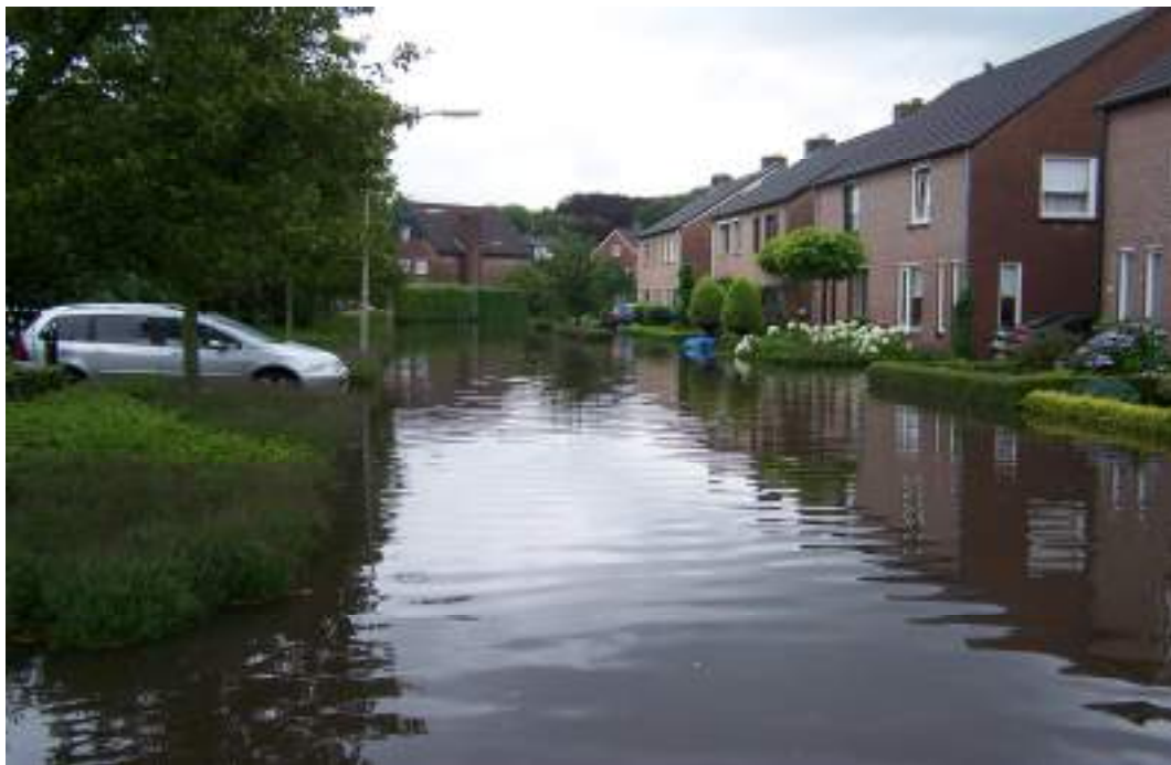
Figuur 2.2 Na een hevige regenbui staan de straten blank in Hoeven door een te krap gedimensioneerde riolering [Foto: M.M. Tromp]
